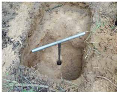
Figura 35. Fotografía del uso del barreno en espiral para determinar la profundidad del suelo, cuando es mayor a 0,50 m.
